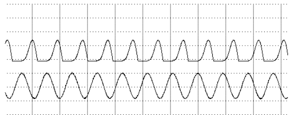
Abb. 5: Periode 1 im U - t - Raum: Spannung an der Diode und Erregerspannung (Y1: 0,5 V/Skt., Y2: 1 V/Skt., X: 1 ms/Skt.).
