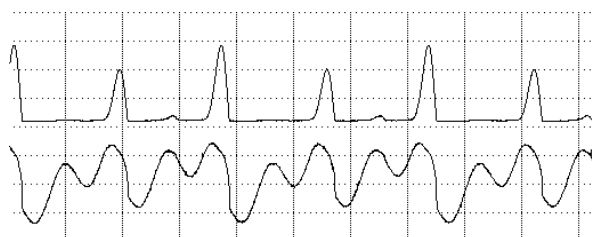
Abb. 18: Periode 4: U_D(t) und I(t) (Y1: 2 V/Skt., Y2: 40 mV/Skt., X: 1 ms/Skt.)
