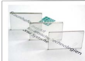
IKTS Dresden: ZrO 2 -Keramikscheiben 2, 3 und 4 mm dick
