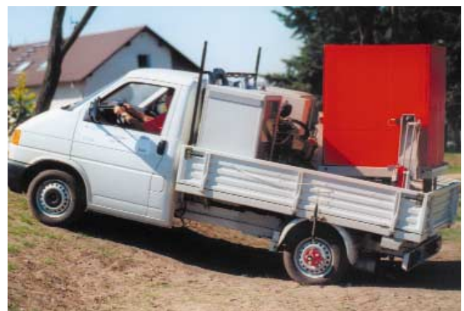
Abb. 9: Die schnelle ERF-Hydraulik sorgt für eine aktive Entkopplung des Transportgutes vom Fahrzeugrahmen 1) .
