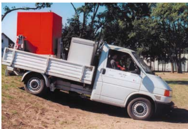
Abb. 9: Die schnelle ERF-Hydraulik sorgt für eine aktive Entkopplung des Transportgutes vom Fahrzeugrahmen 1) .
