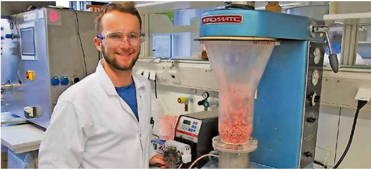
Moritz Reif arbeitet im Pharmazielabor mit einem „Wirbelschichter“, um Tabletten mit einem Überzug zu versehen.
