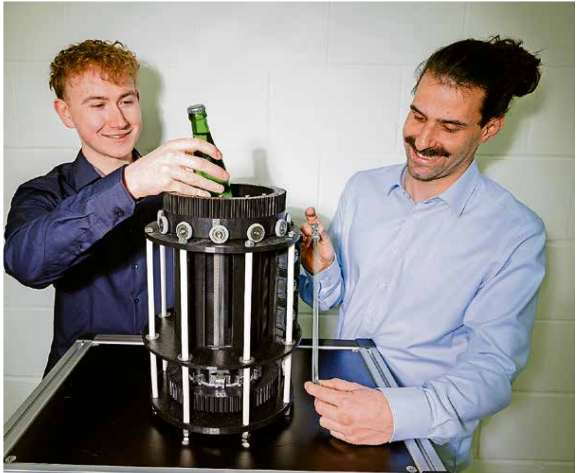
Der weltweit erste Kühlschrank mit künstlichen Muskeln: Student Nicolas Scherer (l.) und Doktorand Lukas Ehl forschen daran mit.
