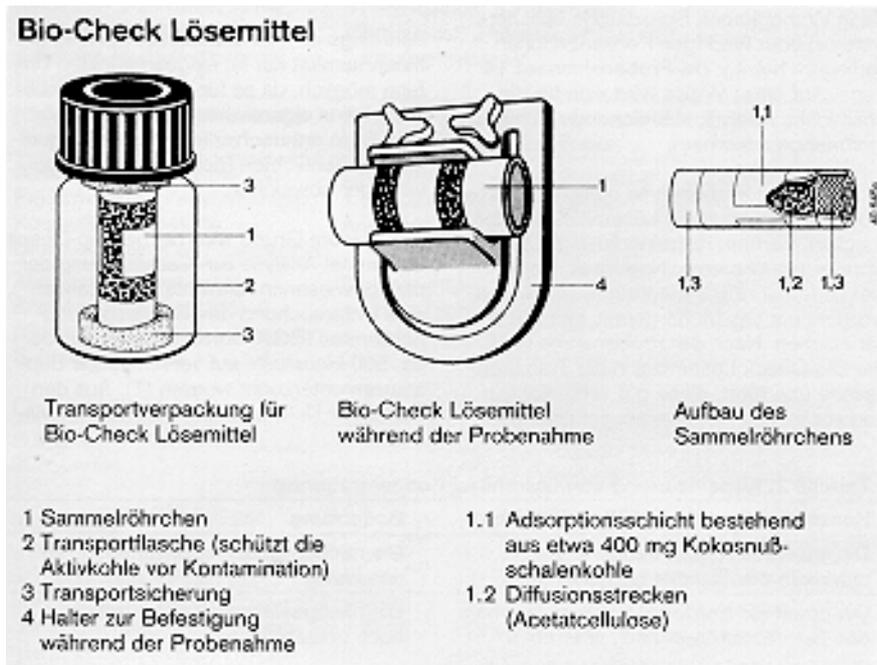
Abb.X: Inhalt und Aufbau des Trägers Bio-Check Lösemittel während der Probenahme
