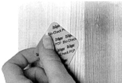
Abb.X: Probenahme auf Holz mittels Träger Bio-Check PCP
