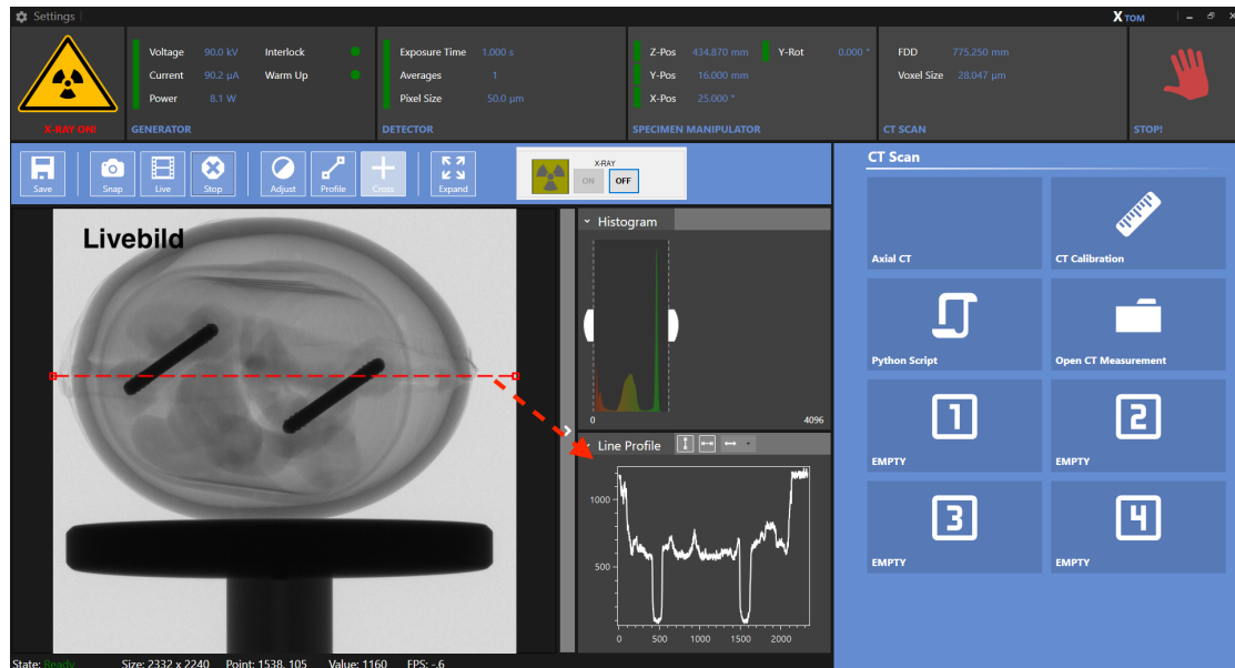
Abbildung 4.1: Übersicht des Hauptmenüs des Programms X-Tom. Im großen, linken Bildfeld kann ein Livebild oder Schnappschuss der Intensitätsverteilung (Radiogramm) dargestellt werden. Hierzu muss das entsprechende Icon ( Live oder Snap ) auf der Leiste oberhalb der Bildfläche angeklickt werden. Radiogramme lassen sich mit dem Icon Save auf dem Rechner abspeichern. Mit dem Icon Live wechselt man wieder auf das Livebild, das mit dem Icon Stop angehalten werden kann. In den mittleren Bildfeldern, werden Histogramme der Grauwerte des Livebildes angezeigt. Auf der rechten Seite benötigen Sie hauptsächlich das Icon Axial CT ; das Fenster, das sich durch anklicken öffnet, ist in Abb. 4.3 dargestellt. Mit dem Icon Open CT Measurement können Sie den Ordner auswählen, in dem Sie Ihre Messungen speichern können. Wenn eine Kalibrierung des Gerätes mit dem Icon CT Calibration benötigt wird, führen Sie diese zusammen mit Ihrem Versuchsverantwortlichen durch.
