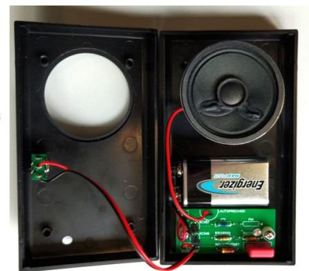
Abbildung 7: Einzelteile und der zusammengebaute Tongenerator.
