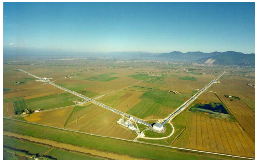
Abb. 4: Das VIRGO-Interferometer zum Nachweis von Gravitationswellen in Cascina/Italien [9].
