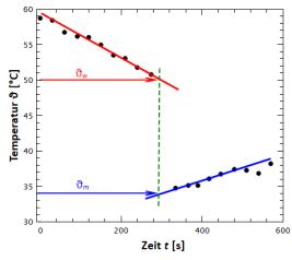
Extrapolation zur Bestimmung der Temperatur des warmen Wassers  $\vartheta_w$  und der Mischtemperatur  $\vartheta_m$ . Hier, wenn ein sehr kalter Körper in das warme Wasser gegeben wird und die Durchmischung nicht optimal ist.
