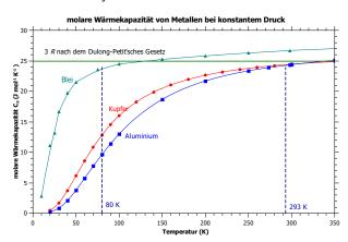
Diese Abbildung zeigt die Temperaturabhängigkeit der molaren Wärmekapazität  $C_p$  von Metallen bei einem konstantem Druck von 1 bar.
