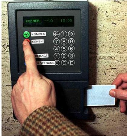
Die Bedienung der Stempeluhren ist leicht. Bei jedem Benutzungsvorgang müssen Sie zunächst die Stechkarte einstecken (siehe Abbildung). Dann wird automatisch die Uhrzeit angezeigt. Wenn Sie kommen, drücken Sie die Taste: KOMMEN. Wenn Sie gehen, drücken Sie die Taste: GEHEN. Wenn Sie sich verdrückt haben, drücken Sie die Taste: C.
