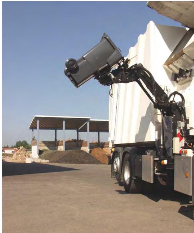
Abb. 80: Müllfahrzeug mit Seitenlader
