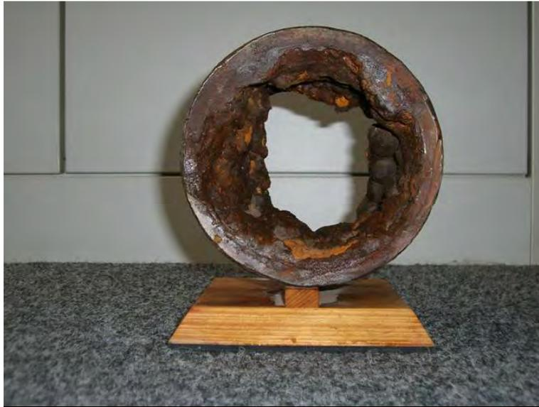
Abb. 14: Stark verkrustetes Wasserrohr
