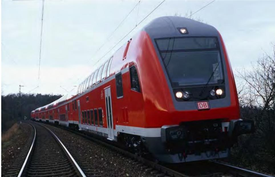
Abb. 98: Doppelstockwagen für den Schienenpersonennahverkehr
