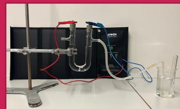
Chemischer Prozess der Wasserelektrolyse
