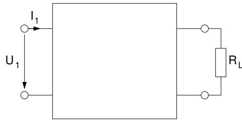
$$\begin{bmatrix} I_1 \\ I_2 \end{bmatrix} = [Y] \begin{bmatrix} U_1 \\ U_2 \end{bmatrix}$$
