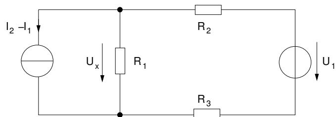
Umwandeln der Spannungs- in eine Stromquelle und weiteres Zusammenfassen:
