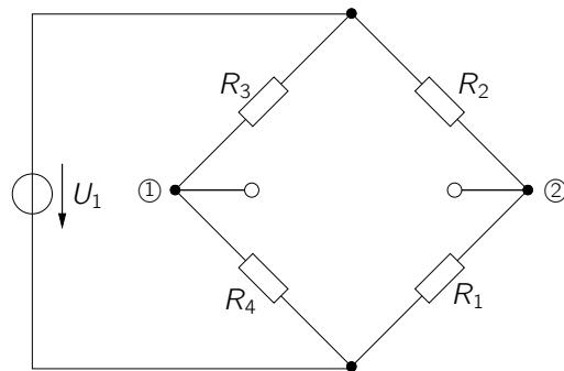
Berechnung der Spannung  $U_{12}$ :
