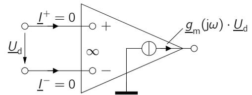
**Abbildung 7:** Links: zu analysierende Transkonduktanz-Verstärkerschaltung. Rechts: Modell des Transkonduktanz-Verstärkers.
