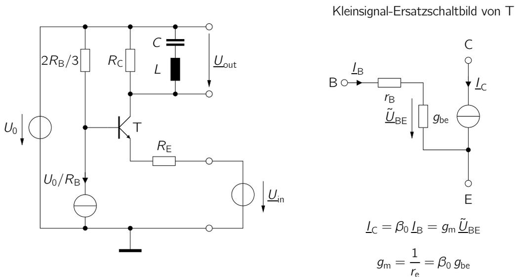
**Abbildung 3:** Links: Zu berechnende Schaltung. Rechts: Kleinsignal-Ersatzschaltbild des Transistors T.
