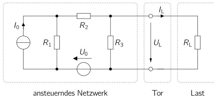
**Abbildung 3.1:** Originalnetzwerk.
