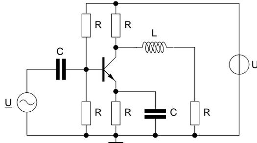
Abb. 2.1: Emittergrundschaltung (EGS) mit induktiver Lastkopplung, Stromgegenkopplungs- und Eingangskondensator.
