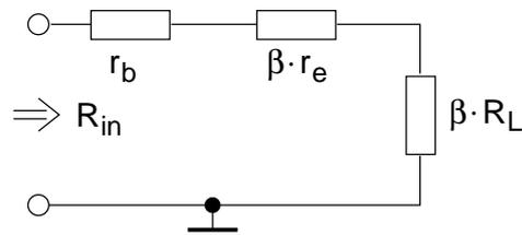
Abb. 3.6: Eingangswiderstand nach Anwenden des T-Operators.
