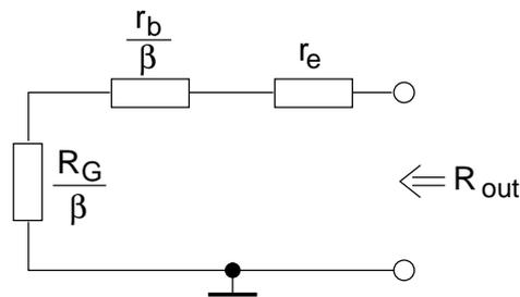
Abb. 3.7: Ausgangswiderstand nach Anwenden des T-Operators.
