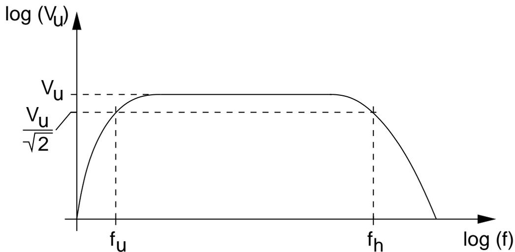
Abb. 5.3: Spannungsverstärkung in Abhängigkeit von der Frequenz.
