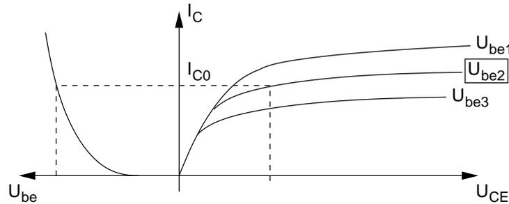
Abb. 4.1: Ausgangskennlinienfeld mit Lastgerade.
