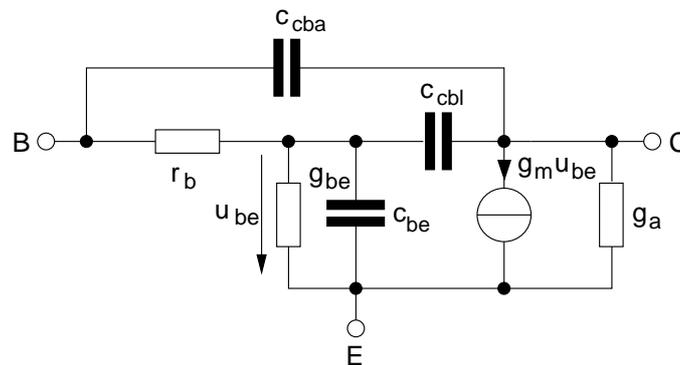
Abb. 2.3: Breitbandiges Kleinsignalmodell des Bipolar-Transistors für hohe Frequenzen.
