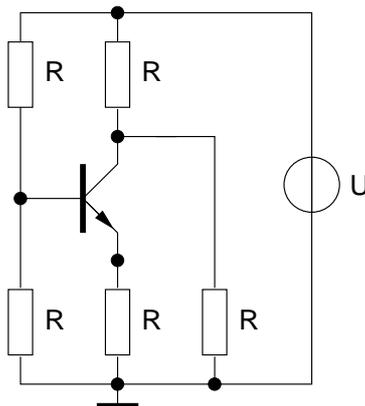
Abb. 2.2: Gleichstromersatzschaltbild der EGS aus Abb. 2.1.
