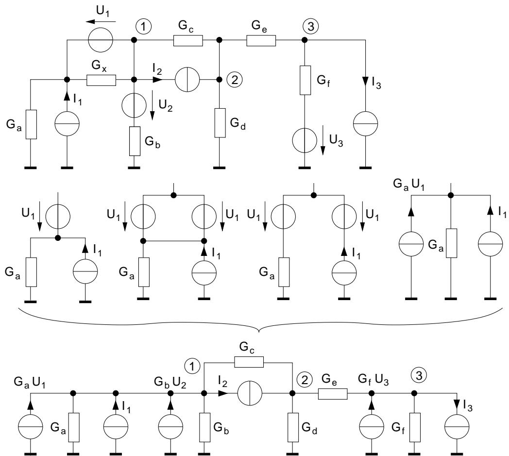
$$\begin{pmatrix} G_a + G_b + G_c & -G_c & 0 \\ -G_c & G_c + G_d + G_e & -G_e \\ 0 & -G_e & G_f + G_e \end{pmatrix} \begin{pmatrix} U_{K1} \\ U_{K2} \\ U_{K3} \end{pmatrix} = \begin{pmatrix} G_a U_1 + I_1 + G_b U_2 - I_2 \\ I_2 \\ -I_3 + G_f U_3 \end{pmatrix}$$
