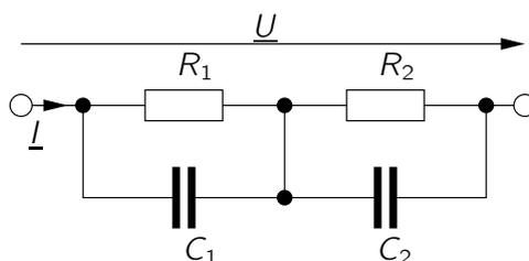
1. Berechnen Sie die Übertragungsfunktion  $\underline{E}(j\omega) = \frac{U}{I}$ .
