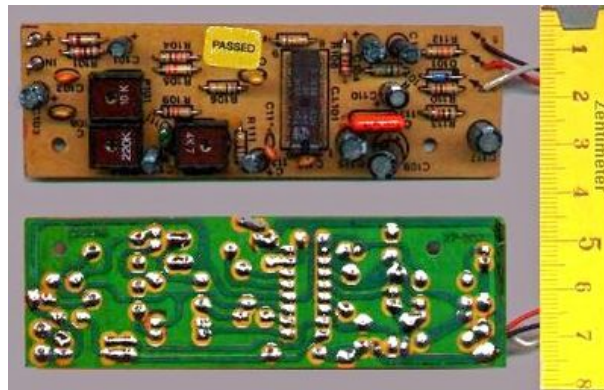
Abb. 5: Beispiel zur Verbindung von elektrischen Bauelementen auf einer Leiterplatte. An den Widerstandsbauelementen in der Abbildung der Oberseite sind die Anschlussdrähte zu sehen, die durch Bohrungen in der Leiterplatte auf die Rückseite (Abbildung unten) geführt werden und dort durch Lot (Zinn-Kupfer Eutektikum) mit den Leiterbahnen aus Kupfer verbunden. Die Leiterbahnen erscheinen in Dunkelgrün aufgrund eines darüber aufgetragenen grünen Lötstopp-Lacks). Die Rückseite der abgebildeten Leiterplatte zeigt somit die Knoten des elektrischen Netzwerks mit ihren Verbindungen (ebenfalls noch Teil der Knoten) zu den Bauelementen auf der Oberseite. Quelle Abbildung Wikipedia
