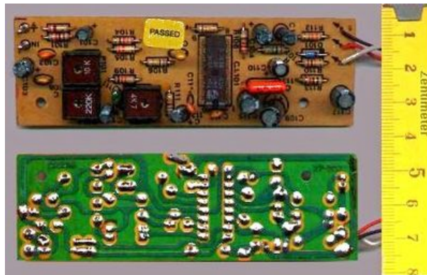
Abb. 6: Beispiel zur Verbindung von elektrischen Bauelementen auf einer Leiterplatte. An den Widerstandsbauelementen in der Abbildung der Oberseite sind die Anschlussdrähte zu sehen, die durch Bohrungen in der Leiterplatte auf die Rückseite (Abbildung unten) geführt werden und dort durch Lot (Zinn-Kupfer Eutektikum) mit den Leiterbahnen aus Kupfer verbunden. Die Leiterbahnen erscheinen in Dunkelgrün aufgrund eines darüber aufgetragenen grünen Lötstopp-Lacks). Die Rückseite der abgebildeten Leiterplatte zeigt somit die Knoten des elektrischen Netzwerks mit ihren Verbindungen (ebenfalls noch Teil der Knoten) zu den Bauelementen auf der Oberseite. Quelle Abbildung Wikipedia
