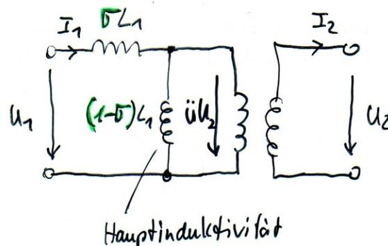
Starke Kopplung:  $k \rightarrow 1 \Rightarrow \sigma = 1 - k^2 \rightarrow 0 \Rightarrow \sigma L_1 \ll (1 - \sigma)L_1$
