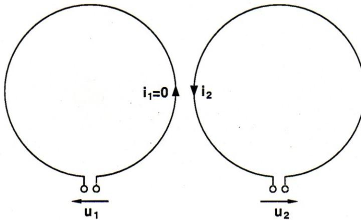
Abb. 4: Spannungen und Ströme an den gekoppelten Induktivitäten nach Abb. 3.
