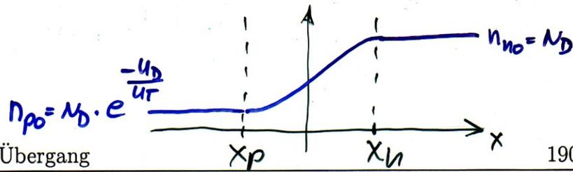
**Beispiel:** Durch den Exponentialterm wird  $n_0(x_p)$  mit den Werten aus den vorangegangenen Beispielen um den Faktor  $e^{-\frac{u_D}{u_T}} = e^{-\frac{900}{26}} \approx 10^{-15}$  gegenüber  $n_0(x_n) = N_D$  reduziert.
